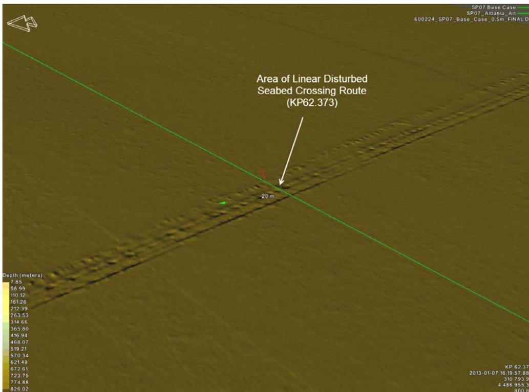
**Figura 4.7 Immagine DTM da Navimodel: lineamento di sedimento disturbato (*Area of linear disturbed seabed*) che attraversa la rotta a KP62.373**
