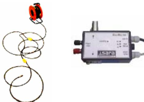
Per il rilievo della velocità del moto del suolo sono stati utilizzati 24 canali d'acquisizione (geofoni verticali Geospace con frequenza di oscillazione di 4.5 Hz), adottando una distanza intergeofonica di 2 metri. È stata eseguita l'elaborazione su un sismogramma ottenuto da un punto di energizzazione posto a 4 metri dal primo geofono.
