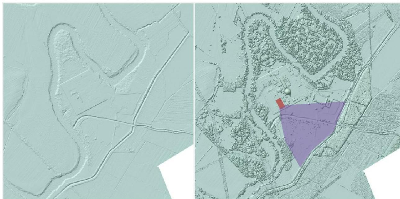
Fig. 8-1 A sinistra immagine DTM dell'area di Centrale e a sinistra il DSM-first con indicazione del bacino visivo da media distanza
