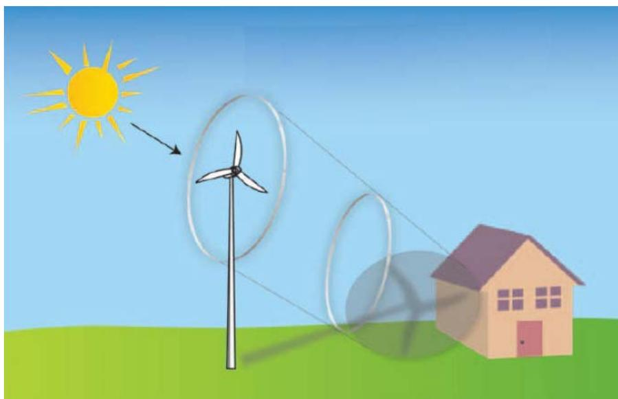
Figura 16. Illustrazione del fenomeno di shadow flickering
