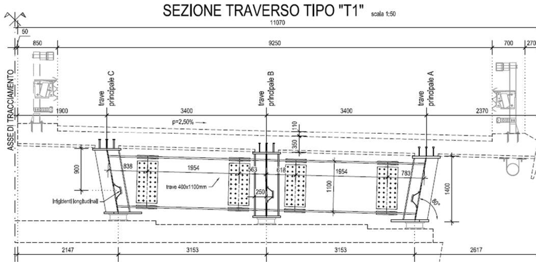
Figura 25 – Sezione trasversale traverso di campata - Viadotto Selargius Centro
