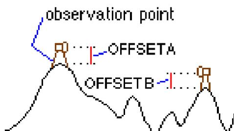
Figura 6.4/1: parametri di input per l'analisi di intervisibilità
