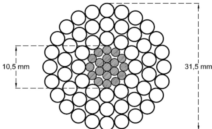
**Figura 3-1 Conduttore a corda di Alluminio-Acciaio**
