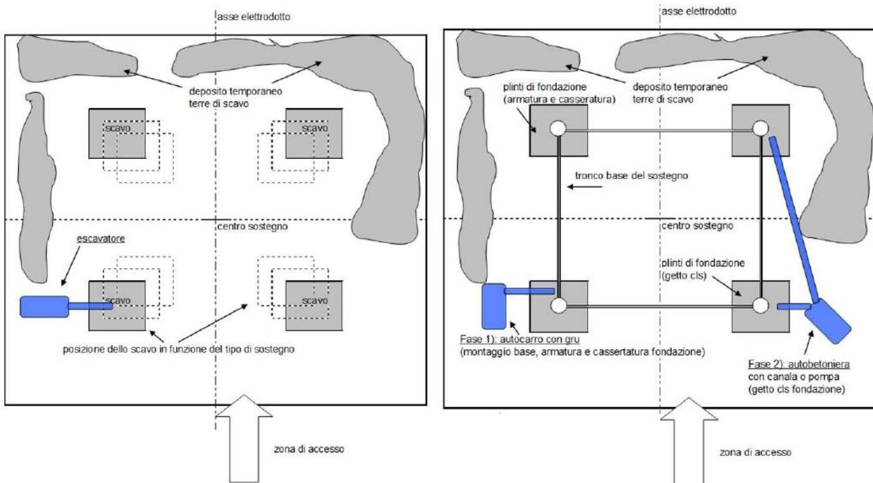
**Figura 3-6 Planimetria dell'Area Sostegno (scavo di fondazione - getto e basi) - Tipologico**
