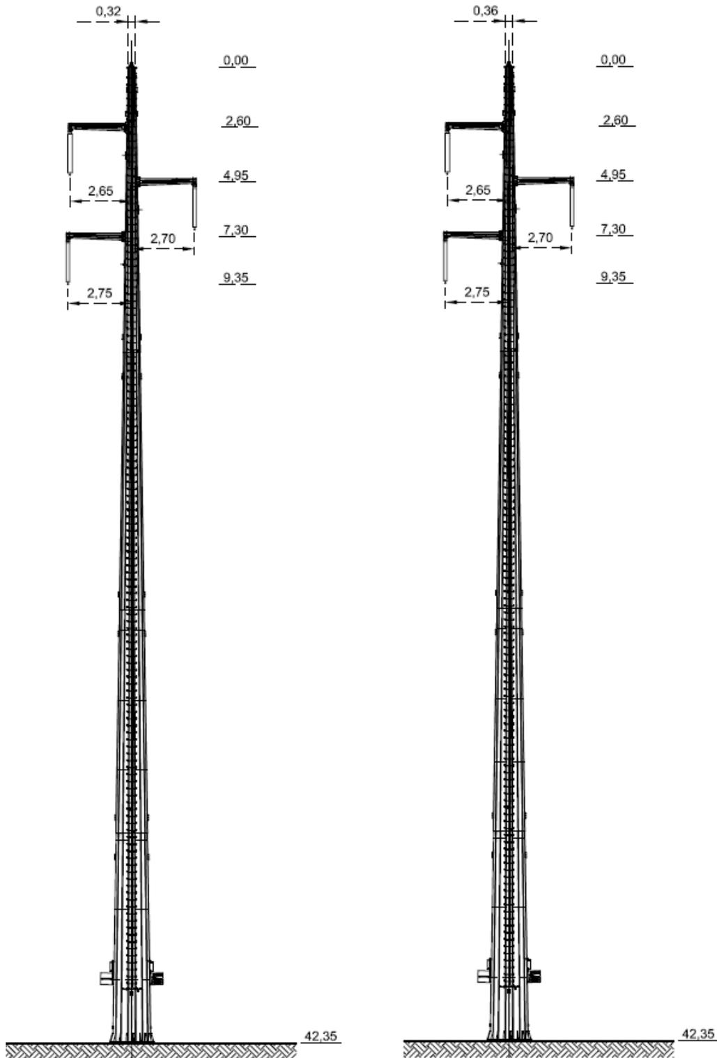
**Figura 3-2** Sostegno tubolare monostelo tipo "M" a sinistra e tipo "P" a destra
