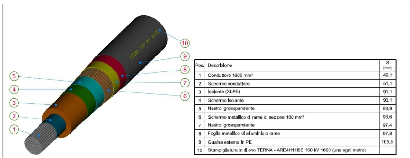
**Figura 3-4 Cavo unipolare isolato Tipo XLPE**
