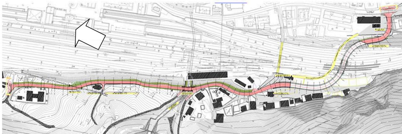
Al fine di permettere il transito dei mezzi di soccorso, saranno realizzati degli interventi di adeguamento dell'esistente via di rio Riol e costruito un nuovo tratto di raccordo con la SS12, in sottoattraversamento all'attuale linea ferroviaria del Brennero.
