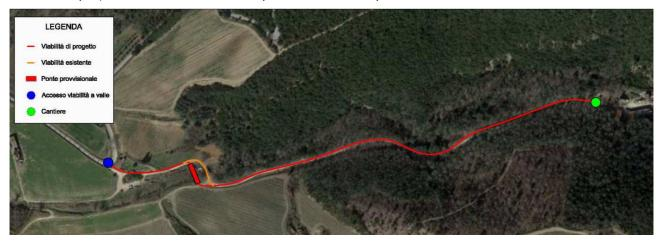
Figura 13 – Localizzazione del punto di accesso, del percorso e del cantiere a valle della diga.
