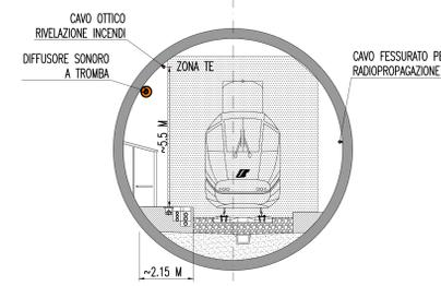
SEZIONE B-B CON IMPIANTI TT E SECURITY
