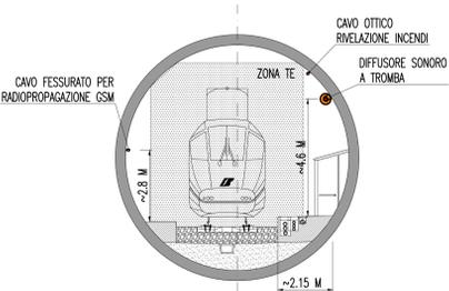
SEZIONE A-A CON IMPIANTI TT E SECURITY
