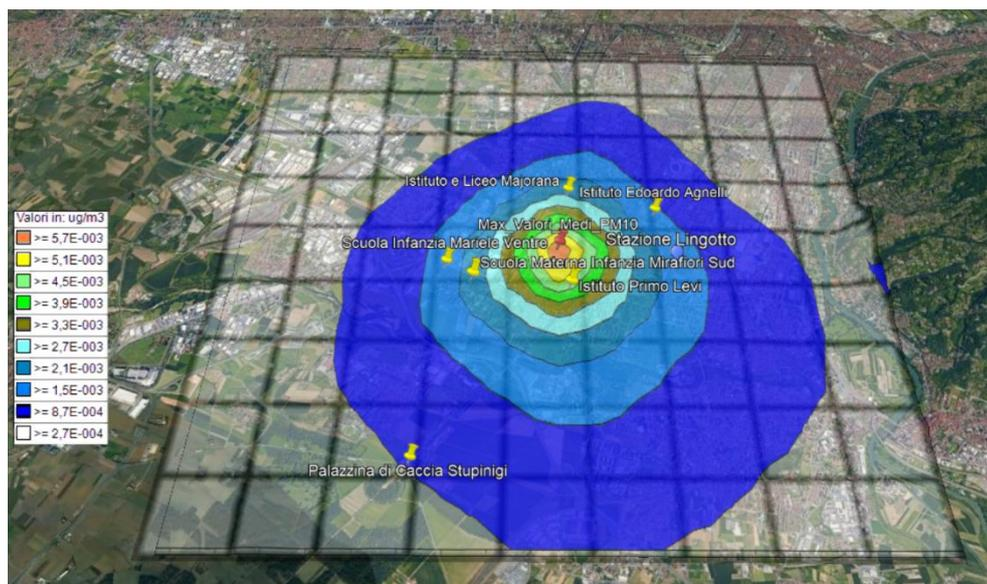
Figura 13 – Rappresentazione delle isolinee di concentrazione media oraria di PM10 ( $\mu\text{g}/\text{m}^3$ ) riferita alle condizioni climatologiche del 2018 e ai dati emissivi di progetto. E' indicata anche l'ubicazione del punto con il massimo valore della serie Valori Medi PM10.
