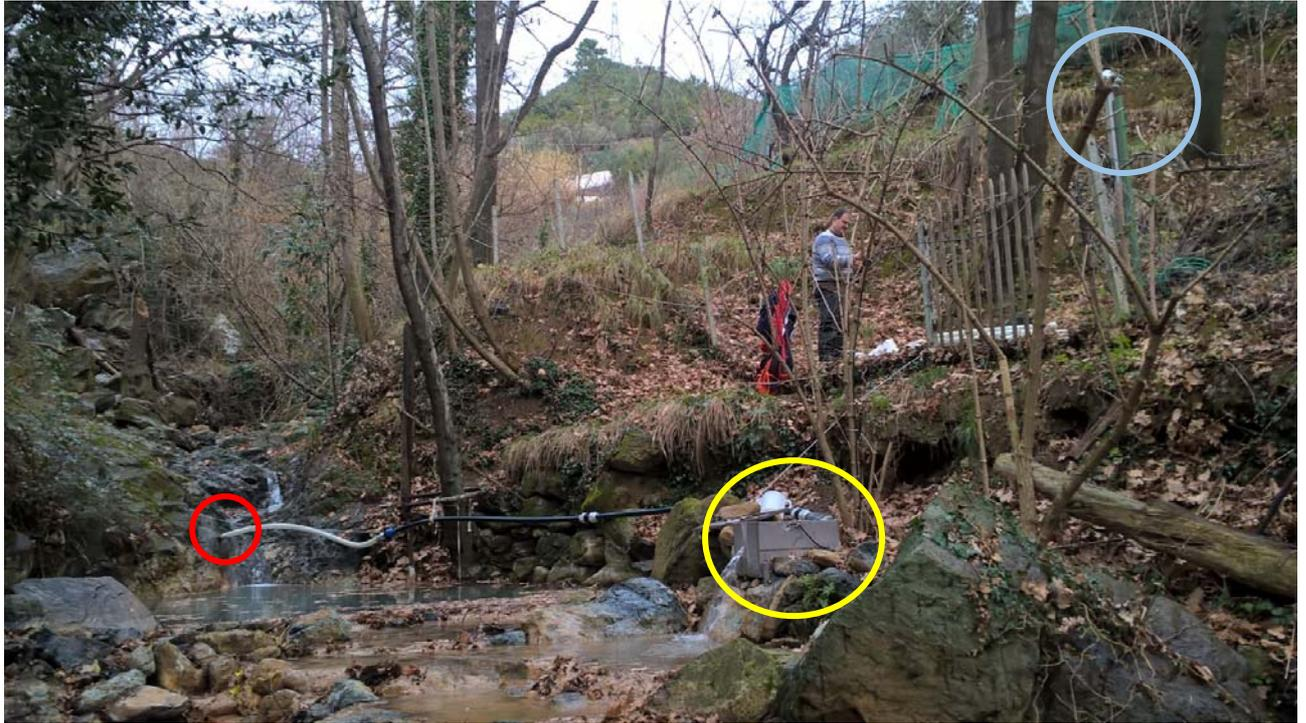
Foto 3: Vista generale dell'installazione (16/01/2019). Presa (cerchio rosso), stramazzo (cerchio giallo) e unità di gestione-trasmissione dati via GPRS, posizionato su palo in sponda sinistra (cerchio azzurro).
