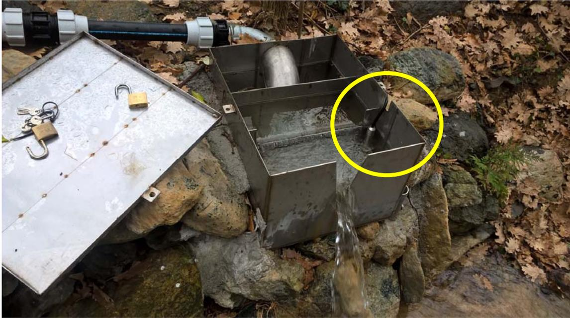
Foto 5: Vista interna della vasca-stramazzo con trasduttore di livello e asta graduata di riscontro.
