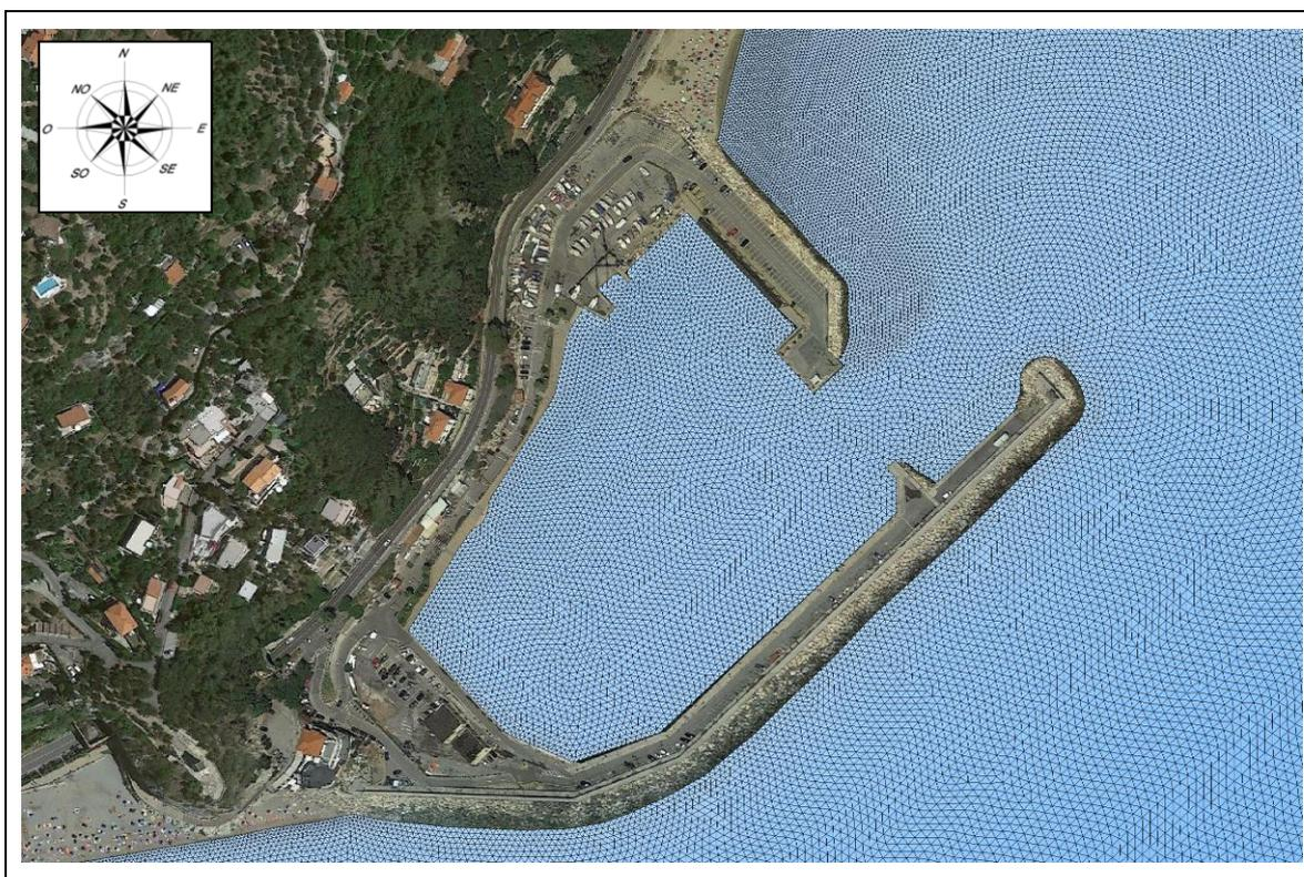
Fig. 6.3 – Particolare della mesh di calcolo in prossimità e all'interno del porto – Configurazione attuale
