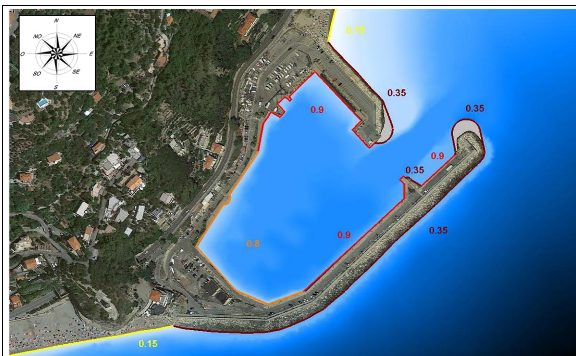
Fig. 6.5 – Coefficienti di riflessione impiegati nello studio dell'agitazione ondosa ipotesi progetto 2 – Fase 2
