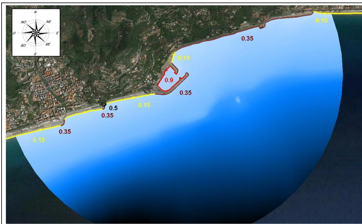
Fig. 6.4 – Coefficienti di riflessione impiegati nello studio dell'agitazione ondosa – Configurazione attuale
