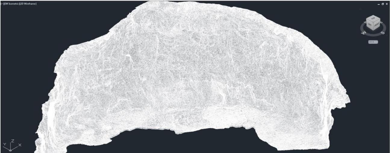
Si è dunque proceduto ad analisi spaziali sulla nuvola di punti georeferenziata nel sistema di coordinate piane UTM fuso 33N (codice EPSG 32633) per estrapolare l'orientazione dei piani strutturali principali distribuiti lungo tutto il fronte di cava, al fine di produrre dati giacitureali integrativi per l'analisi dello stato strutturale della parete interessata dal Progetto.
