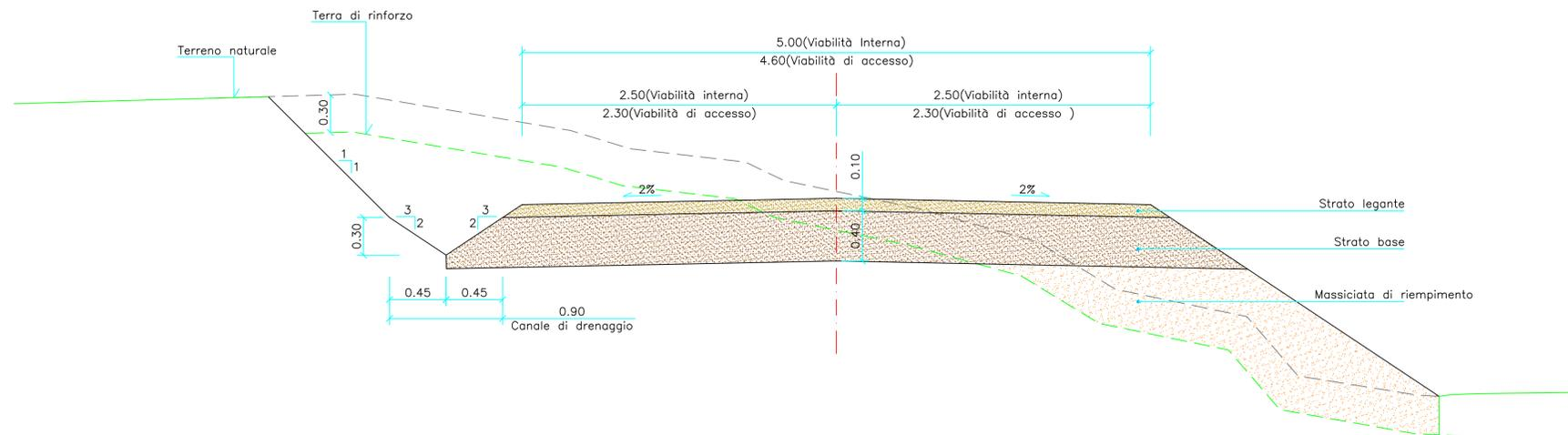
SEZIONE TIPO VIABILITA' (PAVIMENTAZIONE GRANULARE/PIETRISCO)
