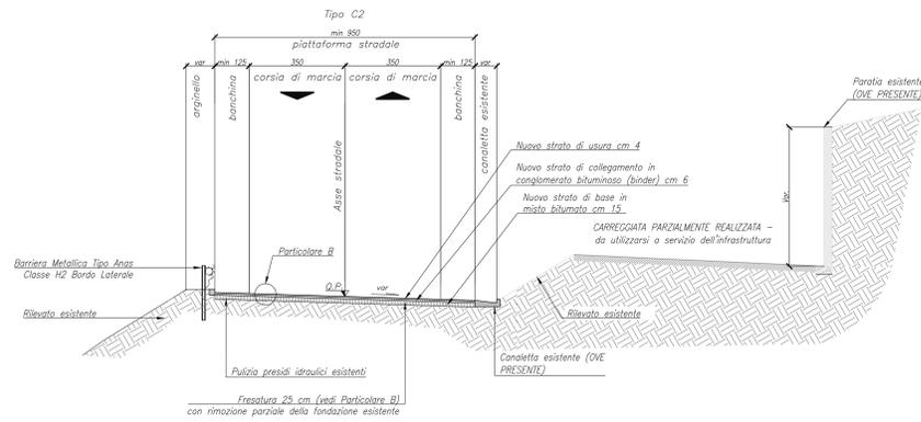
SEZIONE TIPO IN AFFIANCAMENTO A CARREGGIATA DISMESSA CON PARATIA IN DX
