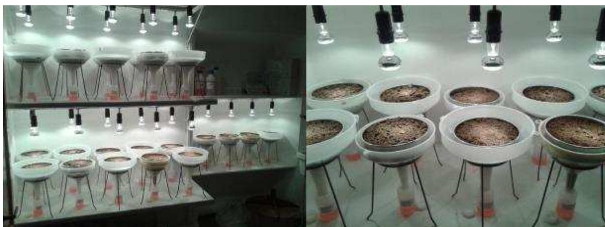
Figura 5. La batteria di estrattori di Berlese-Tullgren utilizzata in laboratorio per l'estrazione dei microartropodi dal suolo, con particolare dei campioni di suolo preparati per l'estrazione.
