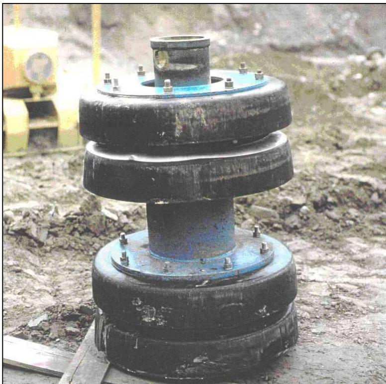
**Fig. 10.1 - Pig convenzionale impiegato nelle operazioni di collaudo idraulico e di pulizia della condotta.**
