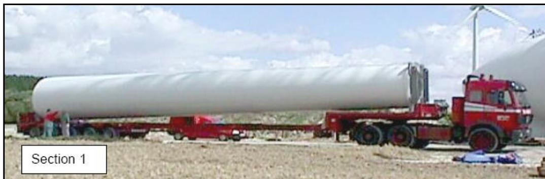
**Figura 12:** trasporto della sezione della torre
