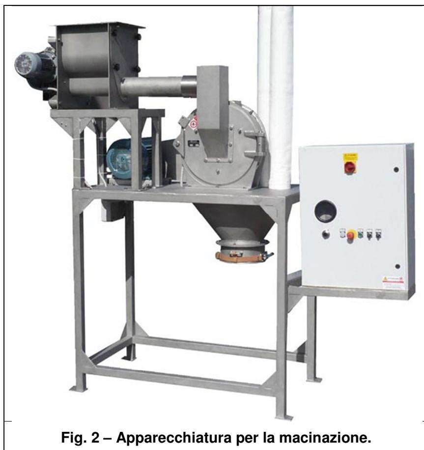
Il mulino preposto alla macinazione fine dei manufatti in cemento-amianto (v. particolare in fig. 3) è costituito da una carcassa cilindrica contenente al suo interno un rotore dotato di martelli. Nella sua parte superiore la carcassa è dotata di due ganasce in ghisa dura, recanti una dentellatura che trattiene il materiale da macinare,
