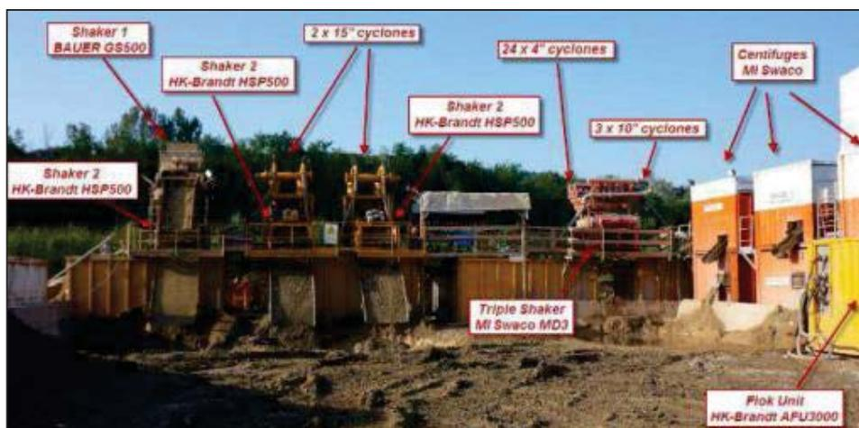
**Figura 38 – Tipico impianto automatico di separazione.**
