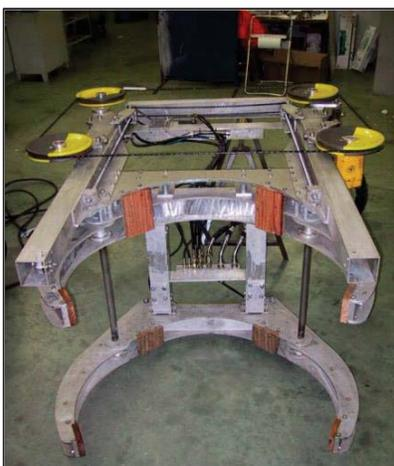
**Figura 12 - Tipico strumento da taglio con filo diamantato**
