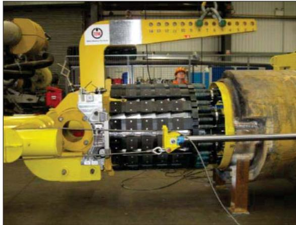
**Figura 13 – Tipico strumento per il recupero (PRT)**
