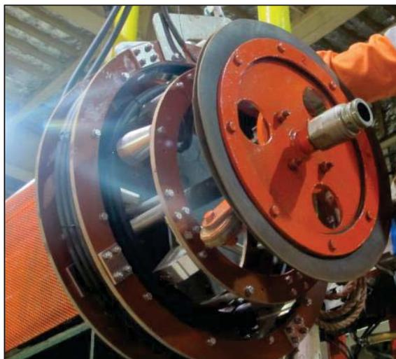
**Figura 14 - Disco flangiato con guarnizione in gomma utilizzato a bordo della nave posa tubi Castoro Sei**
