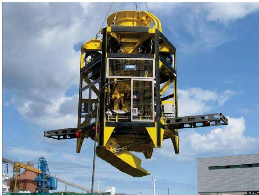
**Figura 51 - Tubo di caduta rocce con ROV (FPROV)**
