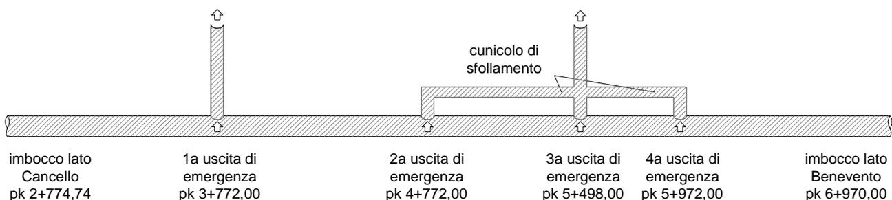
**Figura 3-1 - Rappresentazione schematica uscite di emergenza.**
