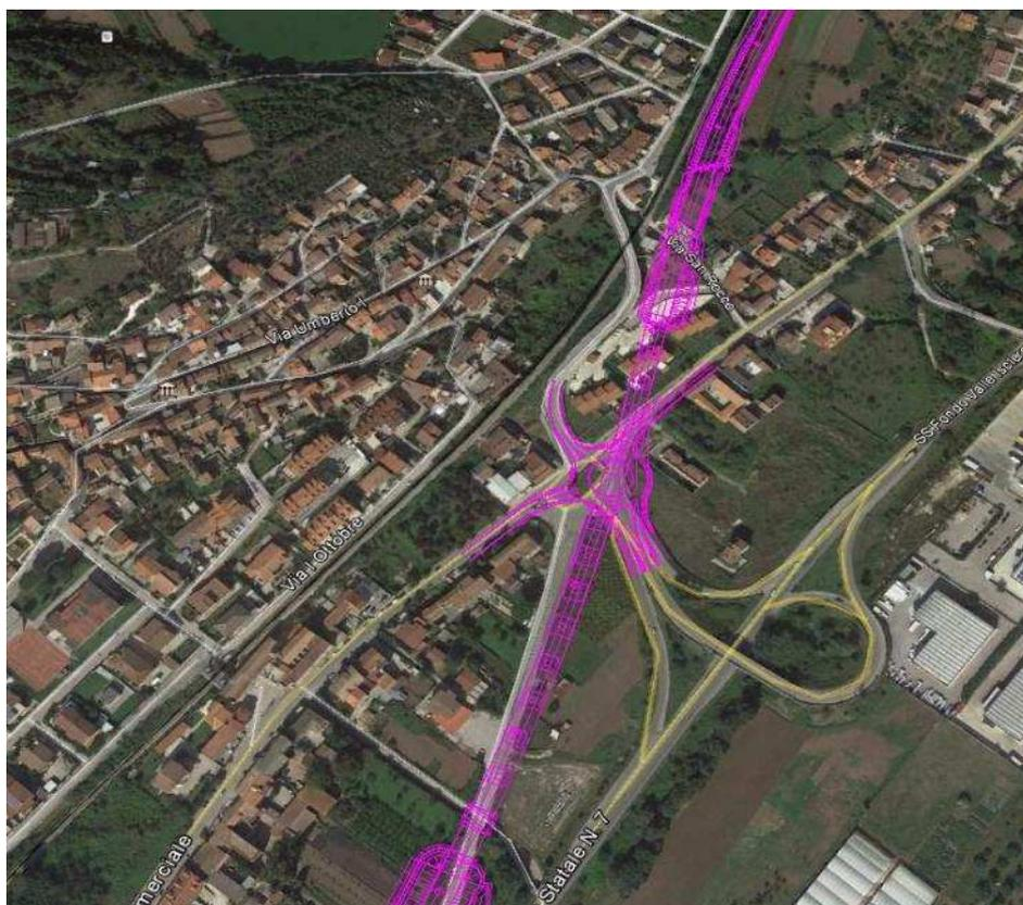
**Figura 4-20 - Interferenza diretta tra la linea in progetto ed alcune case al margine dell'abitato di Valle di Maddaloni.**
