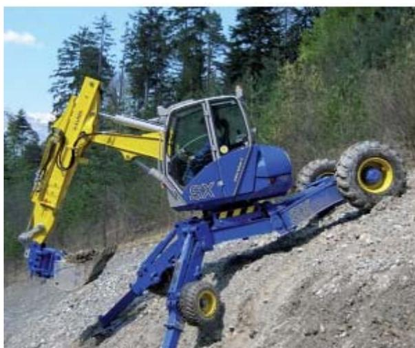
**Figura 13: esempio escavatore tipo "ragno"**
